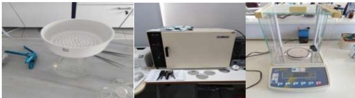
**Εικόνα 12. Όργανα που βοηθούν στον υπολογισμό του ξηρού βάρους των μικροφυκών (χωνί αντλίας κενού, κλίβανος, ζυγός ακριβείας).**
