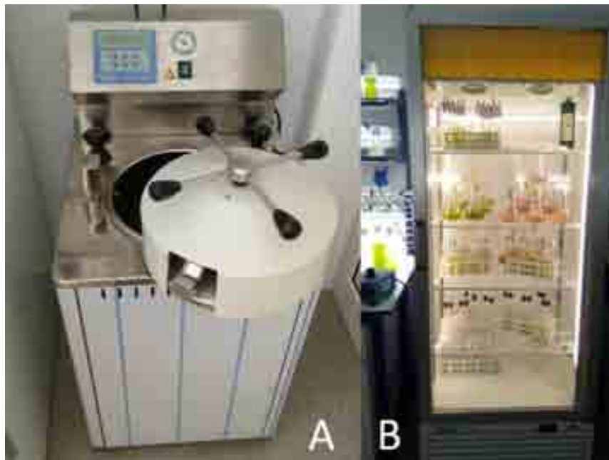
Εικόνα 11. Κλίβανος αποστείρωσης (Α) υπό πίεση (αυτόκαυστο) που χρησιμοποιήθηκε για την αποστείρωση του νερού των καλλιεργειών και των θρεπτικών διαλυμάτων. Θερμοθάλαμος (Β) με τις καθαρές αποθεματικές καλλιέργειες των ειδών φυτοπλαγκτού.
