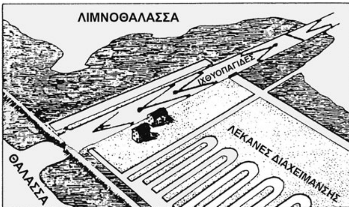
Σχήμα 1.18. Διαγραμματική απεικόνιση των ιχθυοσυλληπτικών εγκαταστάσεων σε μια σύγχρονη βάλα της Β. Ιταλίας. Το συγκρότημα της ιχθυοσυλληπτικής εγκατάστασης βρίσκεται στο μεγάλο κανάλι επικοινωνίας της εσωτερικά οροθετημένης λιμνοθάλασσας (βάλας) με τη θάλασσα.
