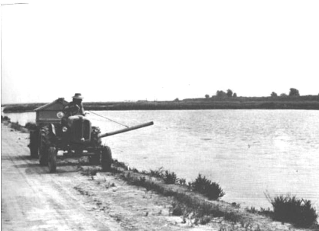
Σχήμα 2.4. Φυσητήρας- διασκορπιστής πέλετς στις δεξαμενές ημιεντακτικής εκτροφής, (Korringa, 1976).
