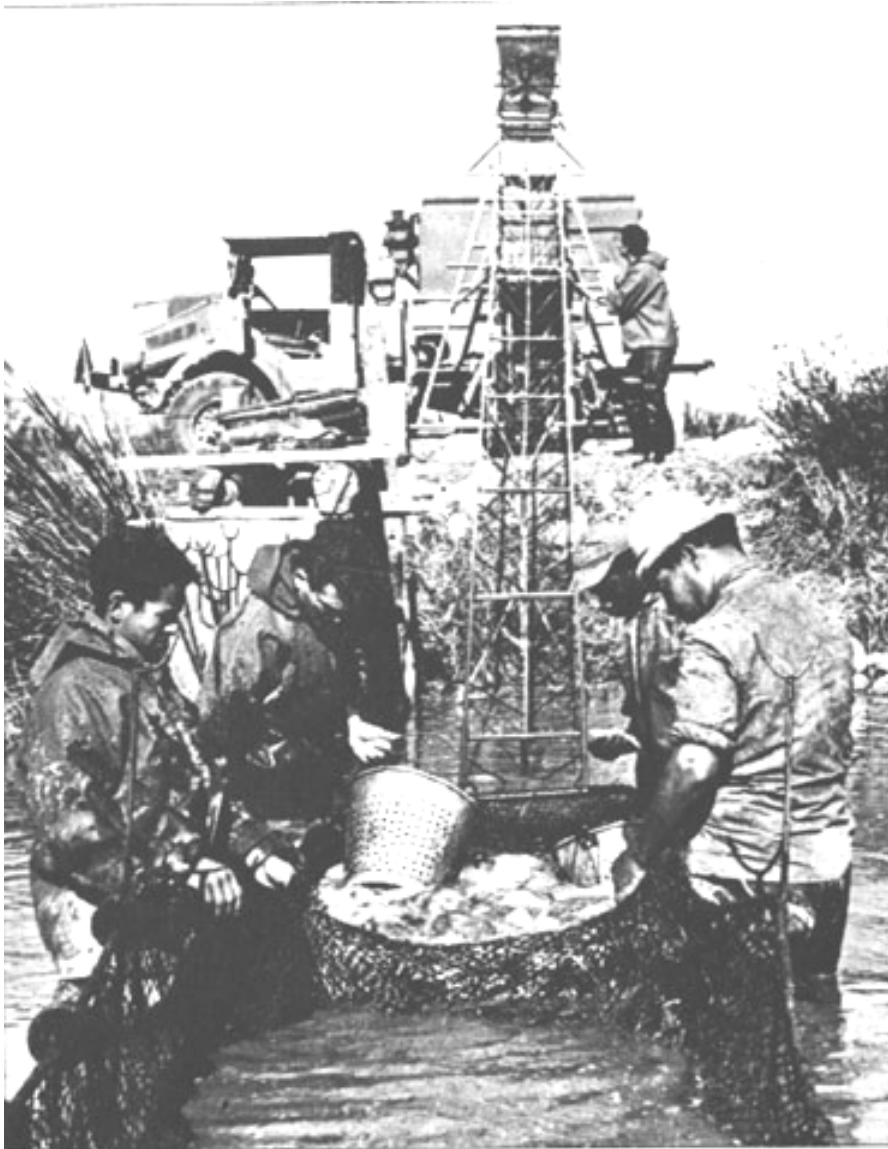
Σχήμα 3.2. Σύστημα μεταφοράς των συλλεθέντων ψαριών από τη δεξαμενή εκτροφής στο δοχείο μεταφοράς. Διακρίνεται η κυλιόμενη σκάλα ανύψωσης και ο διάτρητος κουβάς, (Korringa, 1976) .
