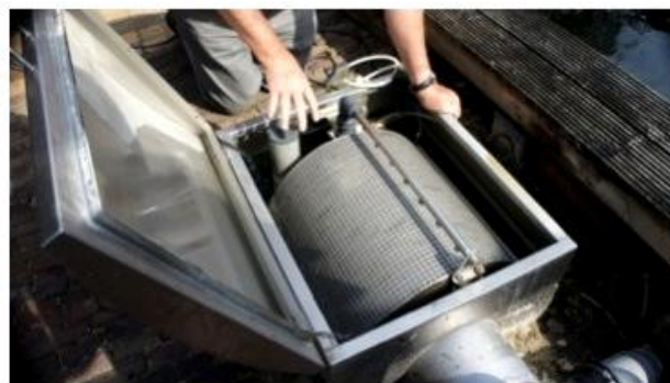
Σχήμα 46. Μηχανικά κοσκινόφιλτρα τύπου τυμπάνου (drum-filters, ή microscreen filters) σε σχετικά μικρά πρακτικά μεγέθη.
