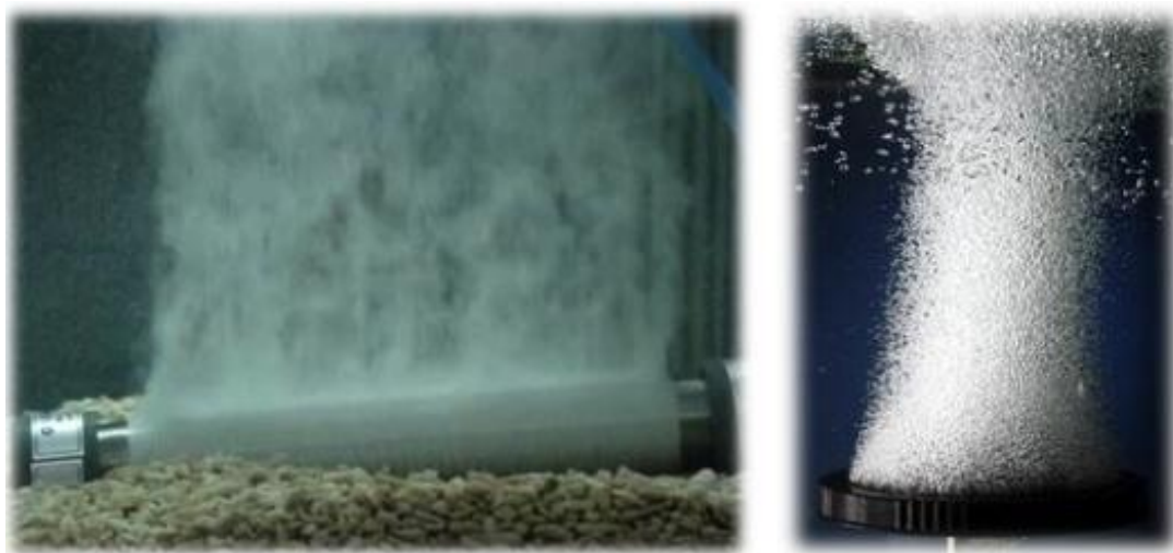
Σχήμα 65. Πολύ μικρές φυσαλίδες αέρα από διαχυτή. Όσο πιο μικρές οι φυσαλίδες τόσο πιο αποτελεσματική η απόδοση του οξυγόνου που μεταφέρουν προς το νερό. Αν οι φυσαλίδες προέρχονται από παροχή καθαρού οξυγόνου, η οξυγόνωση του νερού μεγιστοποιείται.
