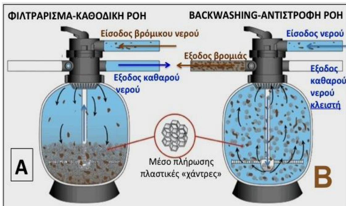
Σχήμα 41. Φίλτρο χαντρών καθοδικής ροής. A: Φιλτράρισμα, B: Backwashing.
