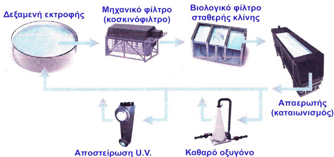
Σχήμα 3. Γενική σχηματική απεικόνιση των βασικών διακριτών μερών που αποτελούν ένα κλειστό σύστημα ιχθυοκαλλιέργειας (κατά J. Brengballe-2015, τροποποιημένο από Γ. Χώτο).
