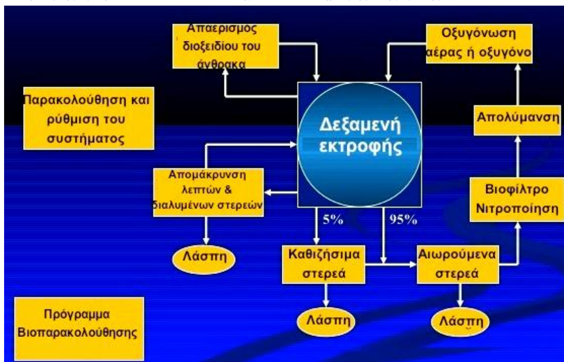
Σχήμα 2. Γενική θεωρητική απεικόνιση διεργασιών σε ένα σύστημα ιχθυοκαλλιέργειας με ανακυκλούμενο νερό.
