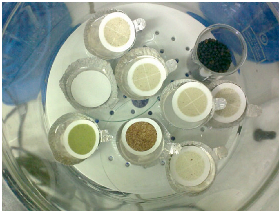
Εικ. 3.8. Φίλτρα WHATMAN σε ξηραντήρα μετά την διήθηση κατά τον υπολογισμό του TSS.
