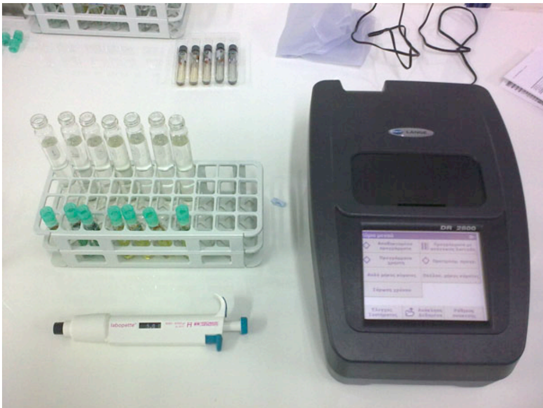
Εικ. 3.4. Φασματοφωτόμετρο το οποίο χρησιμοποιήθηκε για τις αναλύσεις των θρεπτικών αλάτων και τα τυποποιημένα φιαλίδια της κάθε παραμέτρου.
