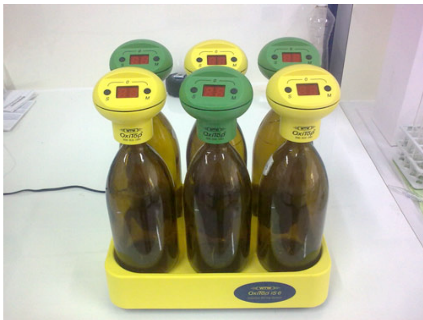
Εικ. 3.6. Διάταξη φιαλών για μέτρηση BOD με μανομετρική μέθοδο.
