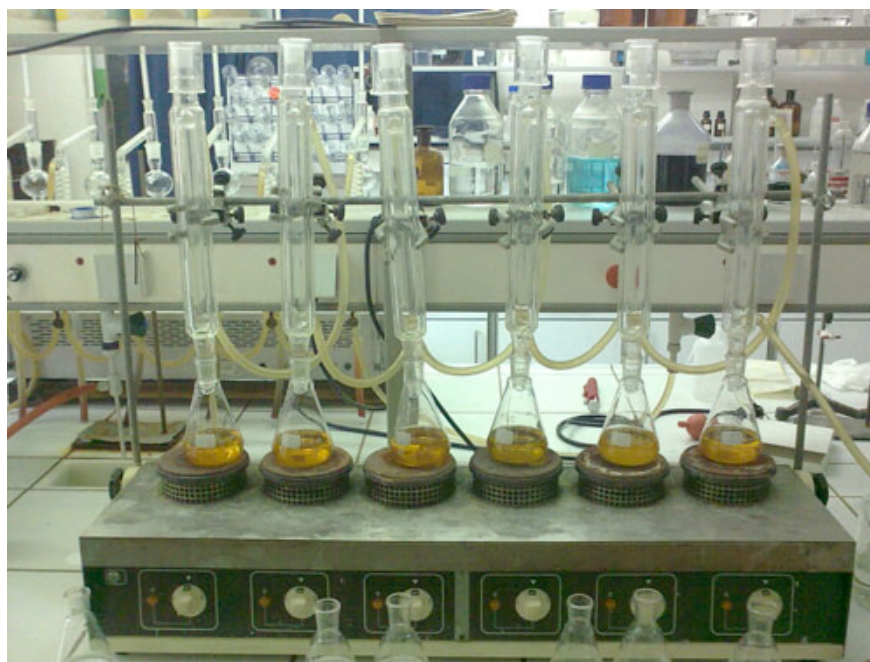
Εικ.3.5. Διάταξη μέτρησης COD με κλασική μέθοδο.
