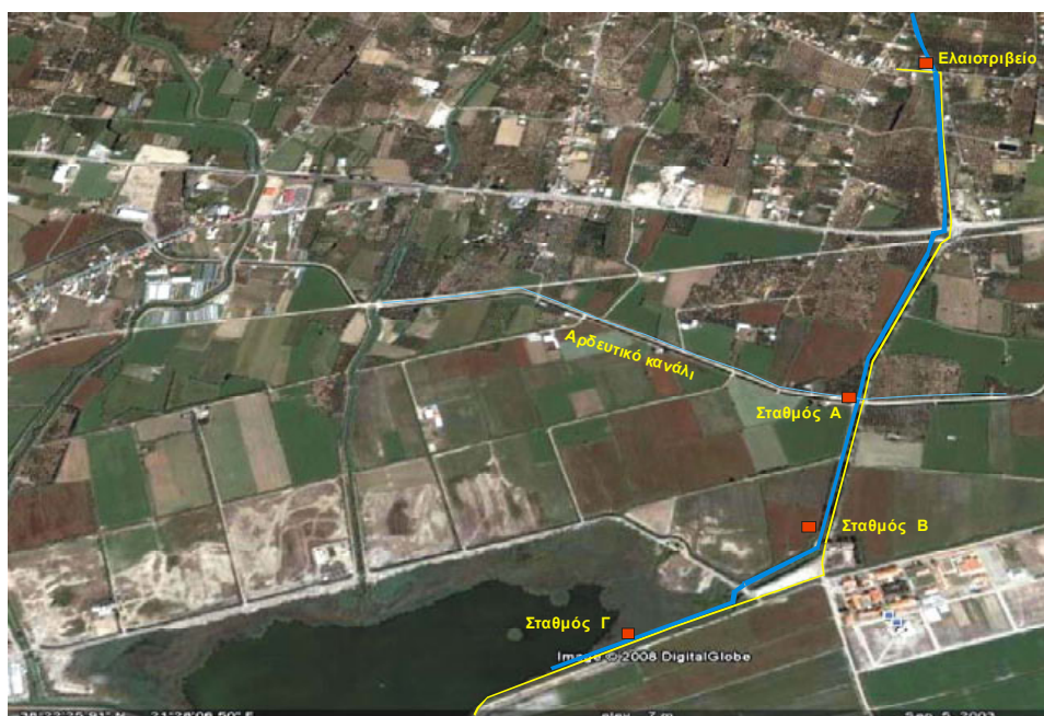
Εικ. 6.1. Δορυφορική φωτογραφία που απεικονίζει τη θέση της υπό μελέτη αύλακας (μπλε γραμμή), του παρακείμενου δρόμου (κίτρινη γραμμή), του αρδευτικού καναλιού (γαλάζια γραμμή), καθώς και τους σταθμούς δειγματοληψίας (Σταθμοί Α, Β και Γ) και τη θέση του ελαιοτριβείου.
