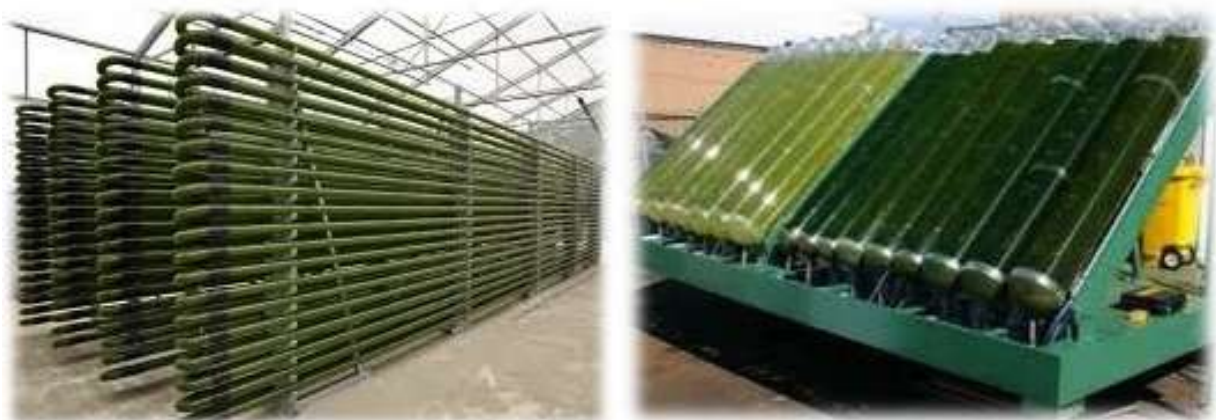
Σχήμα 23. Ειδικές κατασκευές τύπου «φωτοβιοαντιδραστήρες» (photobioreactors) για την τελική ανάπτυξη της φυτοπλαγκτονικής καλλιέργειας. Στους
